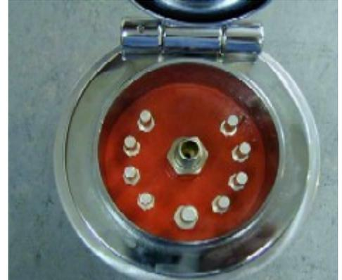
Schottleitner Sofortstartkupplungen wurden speziell für Einsatzfahrzeuge entwickelt, um jederzeit die sofortige Einsatzbereitschaft aller Bordsysteme sicherzustellen. Eine Verbindung zwischen externen Energiequellen und dem Einsatzfahrzeug sowie ein automatisches Lösen im Einsatz werden damit garantiert.
